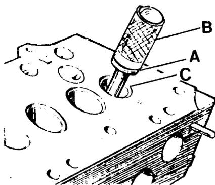
Fig. A3-55 Montaje de asientos postizos de las válvulas de escape
