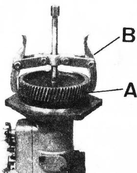
Fig. A3-30 Desmontaje del engranaje de accionamiento
