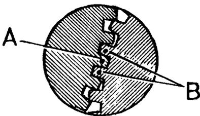
Fig. A3-40 Sincronización de engranajes de árbol de levas y bomba inyectora
