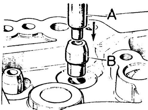
Fig. A3-54 Montaje de guías de válvulas
